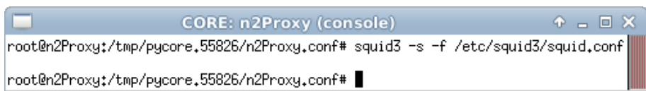
Figura 2.47: resultado da inicialização do serviço de proxy Squid.
