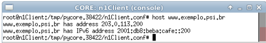
Figura 2.15: resultado da consulta sobre www.exemplo.psi.br oriunda de n1Client .
